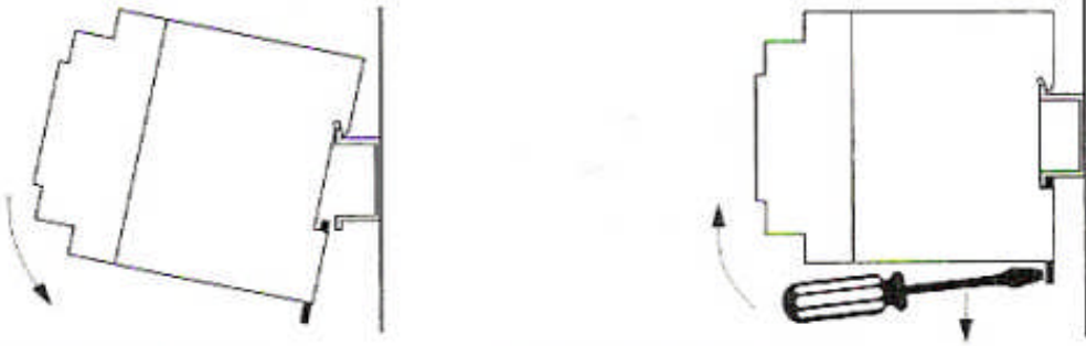
Şekil 2.9: Termistör rölenin raya montajı
